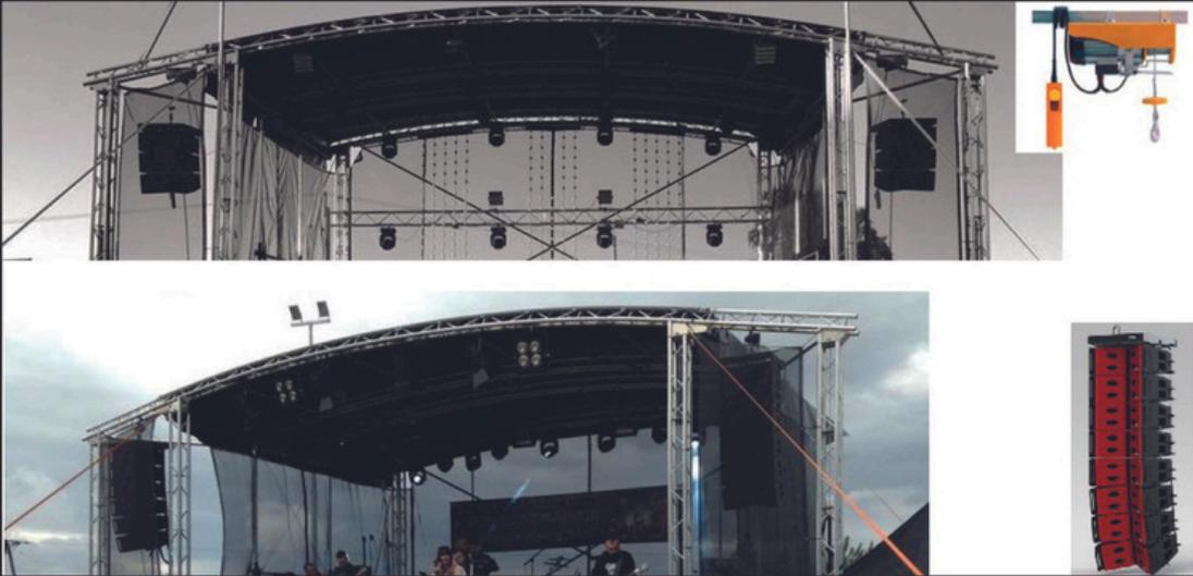
Gagnez du temps et de l'énergie en installant un treuil électrique pour soulever des haut-parleurs en réseau linéaire. Ce mécanisme simple composé de deux treuils alimentés en courant de 240 V soulève un réseau linéaire en plusieurs secondes sans se salir les mains par une chaîne. La charge maximale d'utilisation de treuils s'élève à 200 kg/côté, ce qui correspond à la charge maximale d'une tour.
